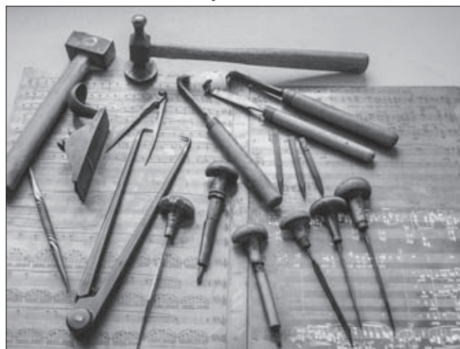
Bild 3: Gravurwerkzeuge: Mitte oben: Drei Rastrale zum Ziehen unterschiedlich breiter Notenlinien; Unten: Stichel für Bindebögen, Notenlinien und Balken
